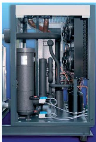
Der Kältetrockner des HybriDryers mit aufgespaltetem Luftkreislauf-System.
